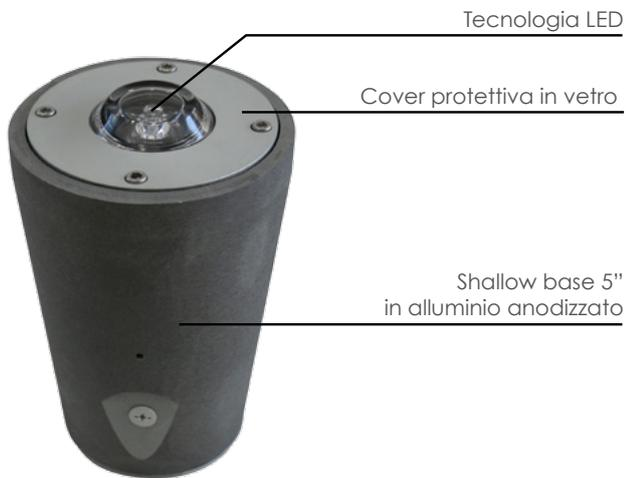
Installata ai bordi dell'area FATO, ne definisce il perimetro. Ha struttura incassata e carrabile che richiede la realizzazione di un pozzetto interno alla pavimentazione della superficie. **In alternativa, è possibile installare il prodotto cod. PHL-LXS-FATO.**
