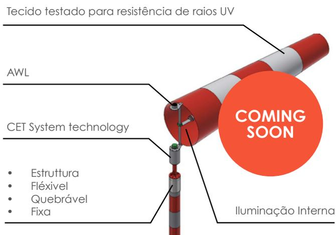
AS LUZES INTERNAS DA MAV E DOS AWL SÃO ALIMENTADOS COM UM MODERNO SISTEMA CET (TRANSMISSÃO DE ENERGIA SEM CONTATO) PARA TRANSFERÊNCIA SEM FIO DA ENERGIA DA PARTE FIXA E TAMBÉM DA PARTE MÓVEL DA MAV. ALIMENTAÇÃO ELÉTRICA SEM CONTATO.
