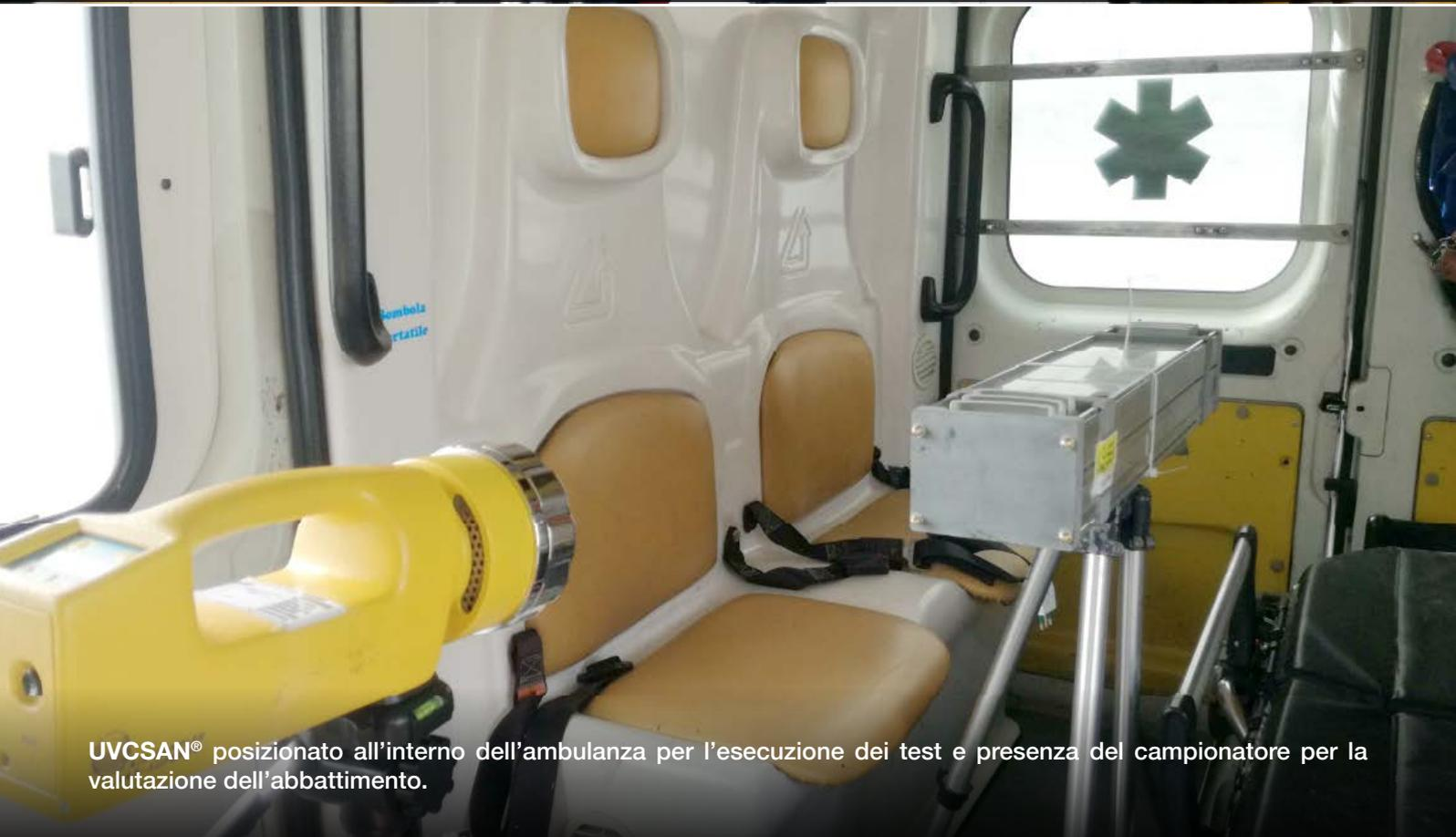
UVCSAN® posizionato all'interno dell'ambulanza per l'esecuzione dei test e presenza del campionatore per la valutazione dell'abbattimento.
