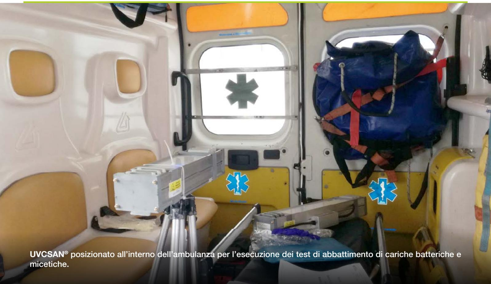
UVCSAN® posizionato all'interno dell'ambulanza per l'esecuzione dei test di abbattimento di cariche batteriche e micetiche.
